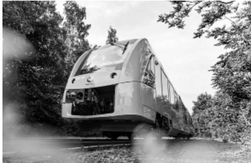
Beim „Coradia iLint“ befinden sich die Wasserstofftanks ganz diskret hinter Verkleidungen auf dem Dach. Der Wasserstoff wird bei einem Druck von 350 bar gespeichert. Mit dem so produzierten Strom werden Batterien geladen, die bei Spitzenverbrauch die nötige Energie liefern.
